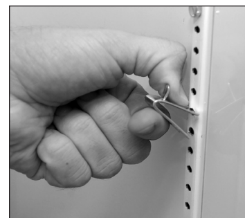
Abb. 7. Die untere Lasche des Halters passt genau in die entsprechende Aufnahmebohrung.
