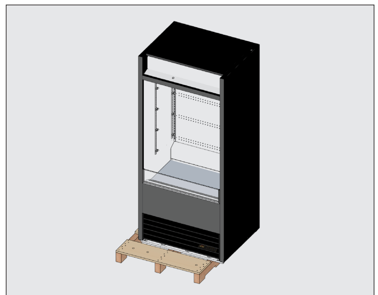
Abb. 3. Den Schrank von der Palette heben und die Palette beiseite legen.
