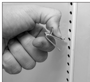
Abb. 6. Befestigung der oberen Lasche des Halters
