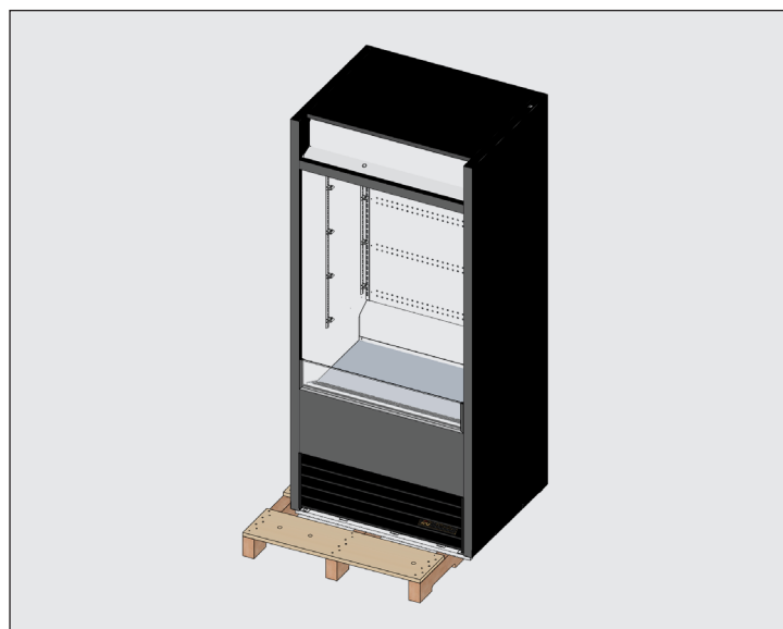
Fig. 3. Retirez l'armoire du patin en bois et mettez-la de côté.
