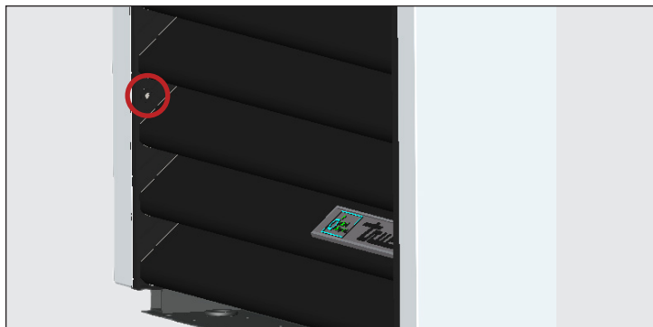
Fig. 1. Retire los tornillos de los costados de la rejilla apersianada.
