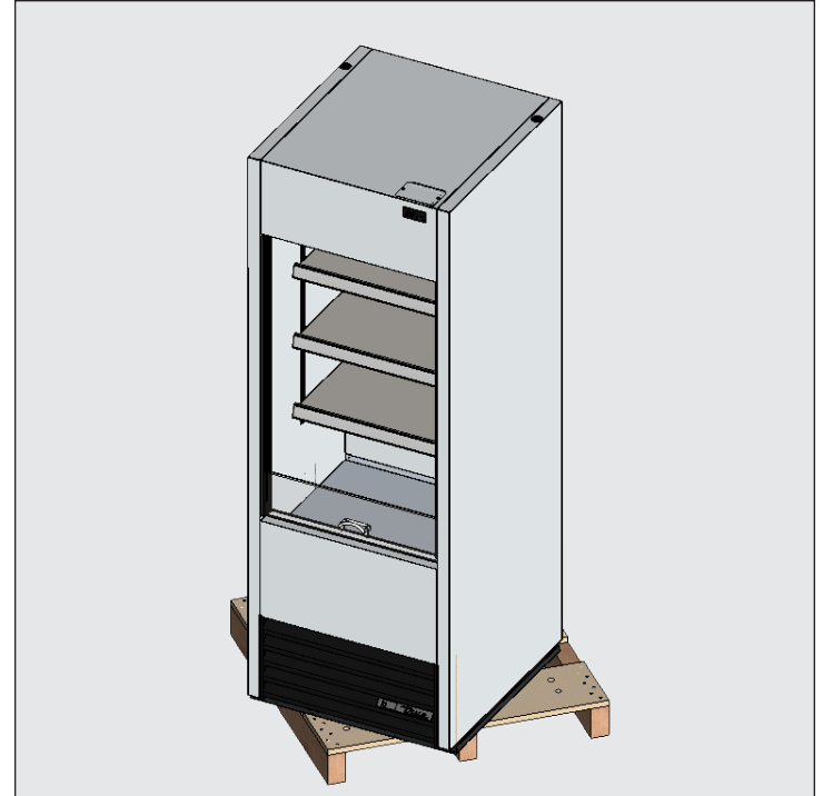
Fig. 3. Al elevar el equipo, no use encimeras, puertas o cajones ni rejillas como punto de elevación.
