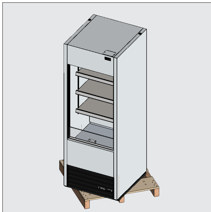
Fig. 3. Pour le levage de l'appareil, ne pas utiliser les plans de travail, les portes/tiroirs ni les grilles comme point de levage.
