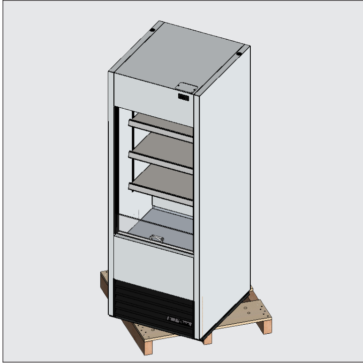
الشكل 3. عند رفع الوحدة، لا تستخدم المناضد والأبواب/ الأدراج أو الشبكات كنقطة رفع.
