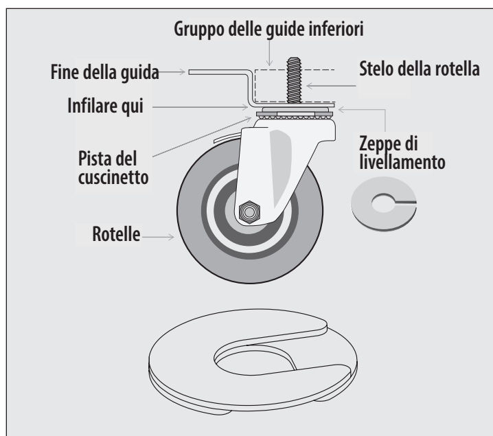
Fig. 4. Rotelle con stelo e zeppe. Installare molteplici zeppe con scanalature equilibrate.
