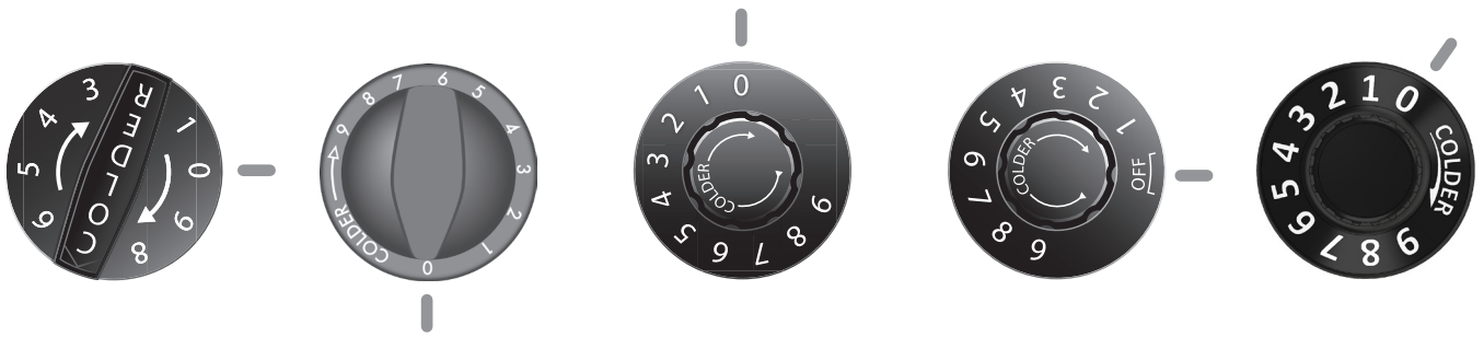
Abb. 1. Temperaturregelungsknöpfe in der Position AUS (Bilder nicht maßstabsgetreu).
