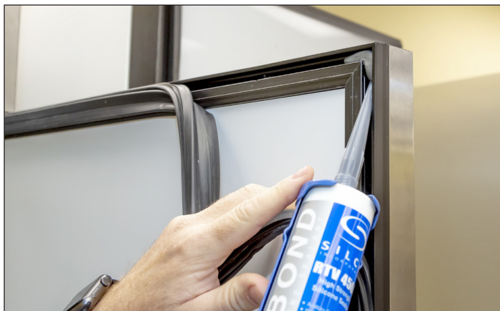
Fig. 3. Aplique silicona en cada esquina del surco de la junta.
