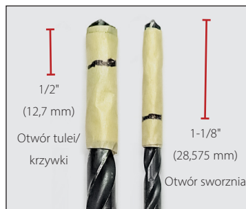
Rys. 8. Zaznaczyć głębokość otworów na wiertłach.
