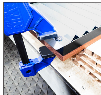
Rys. 2. Wyśrodkować nakładkę i kratkę na narożnikach. Panel jest nieco większy niż kratka.
