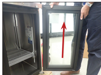
Rys. 2. Podnieść drzwi, aby odłączyć je od dolnego zawiasu.
