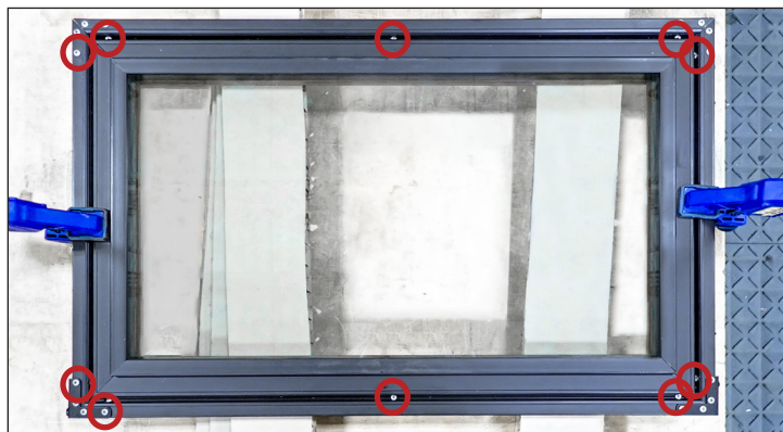
Rys. 7. Miejsca nawiercenia otworów w drzwiach szafy.
