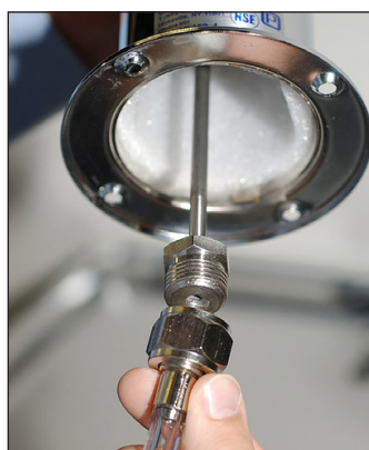
Rys. 3. Podłączyć łącznik przewodu piwna do ramienia nalewaka.
