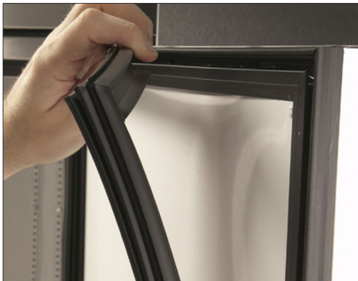
Rys. 2. Wyciągnąć uszczelkę zaczynając od górnego rogu.
