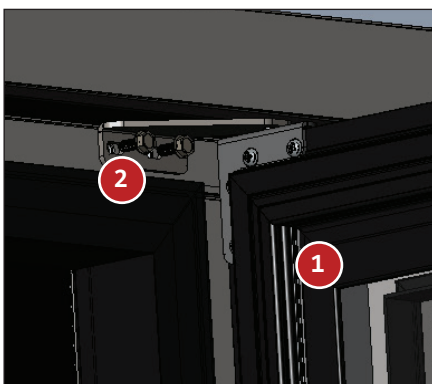
Rys. 10. Zamontować górny zawias i drzwi.
