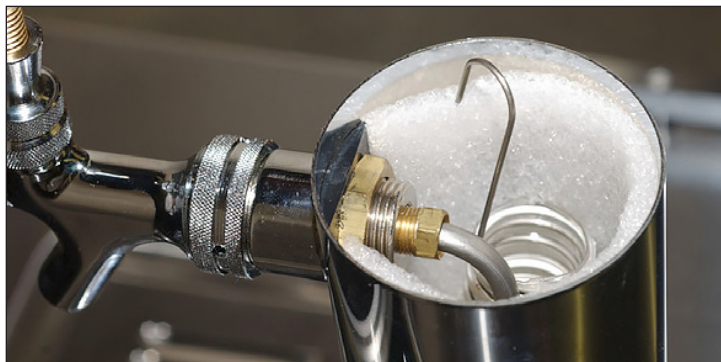
Fig. 8. Agganciare la clip del tubo di raffreddamento sopra alla linea della birra.
