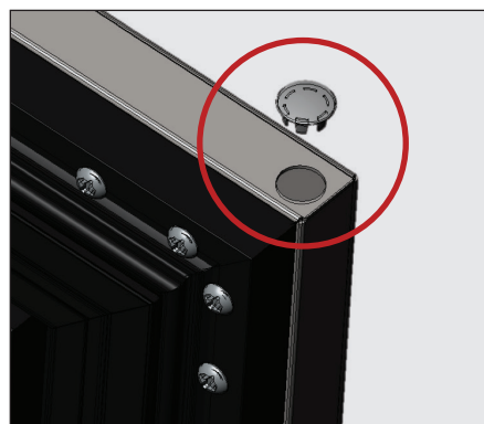
Fig. 11. Installare il tappo.
