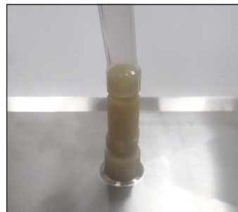
Abb. 5. Am Rohr der Auffangwanne befestigter Schlauch.
