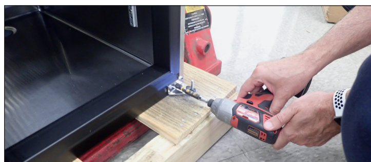
Abb. 7. Das untere Scharnier gegenüber der Türöffnungsseite anbringen.
