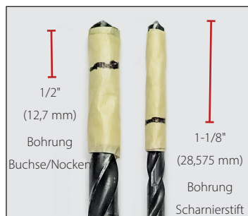
Abb. 8. Die Bohrtiefe an den Bohrern markieren.
