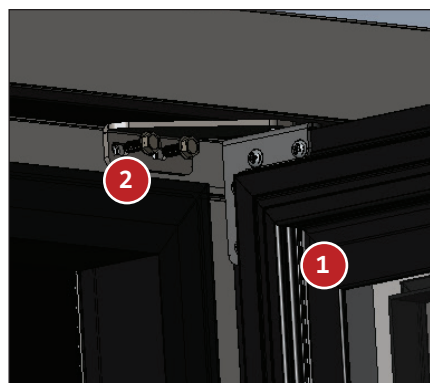
Abb. 10. Oberes Scharnier und die Tür anbringen
