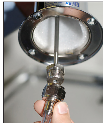
Abb. 3. Anbringen des Bierschlauchanschlusses an der Schanksäule
