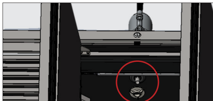
Fig. 1. Emplacement de l'installation de l'écrou du tube du bac de rétention.
