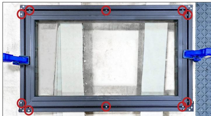
Fig. 7. Emplacements des trous prépercés dans la porte de l'armoire.
