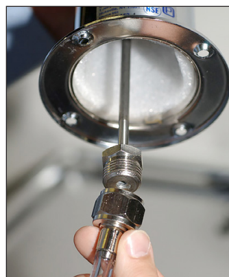
Fig. 3. Fixez le connecteur du conduit de bière au bras de tirage.
