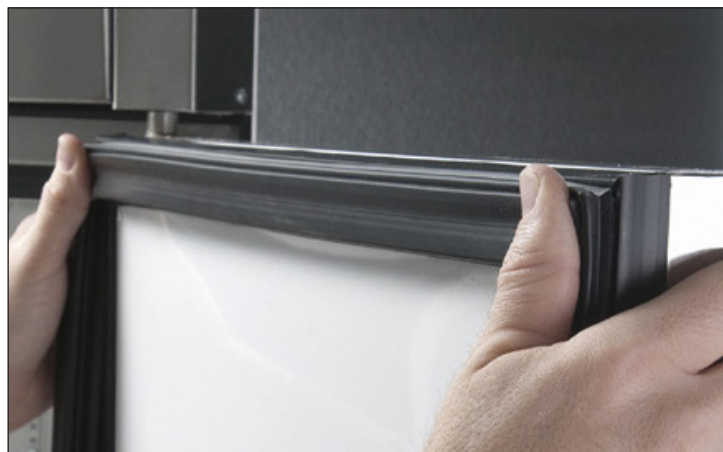
Fig. 4. Il est fréquent de voir du silicone poussé hors du rail autour du joint. C'est ainsi que vous savez que vous avez utilisé suffisamment de silicone.
