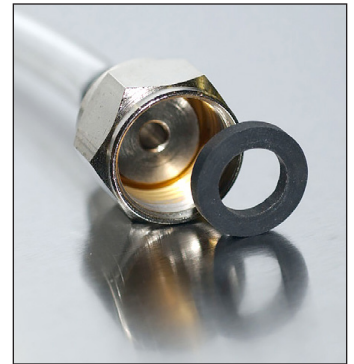
Afb. 2. Leg de O-ring in de koppeling voor de bierleiding.
