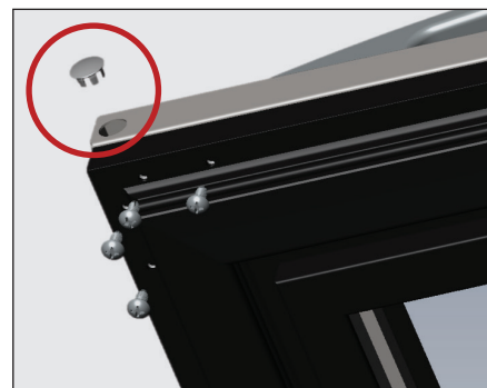
Afb. 6. Verwijder de deurpluggen en resterende schroeven.
