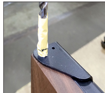
Afb. 9. Boor eerst het 3/8"-gat. Boor DAARNA het 17/64"-gat.
