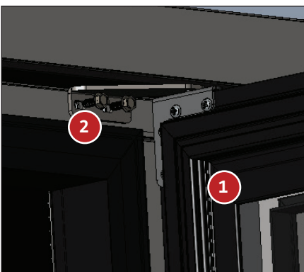
Afb. 10. Installeer het bovenste scharnier en de deur.
