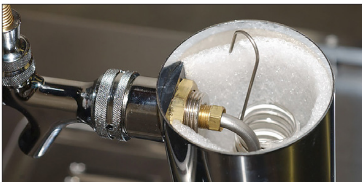
Afb. 8. Hang de koelslangklem over de bierleiding.
