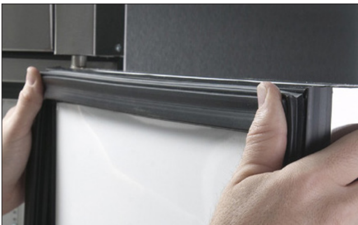
الشكل ٤. من المعتاد رؤية السيليكون يتسرب خارج المسار حول الحشية. وبهذه الطريقة يمكنك معرفة ما إذا كنت قد استخدمت كمية كافية من السيليكون.
