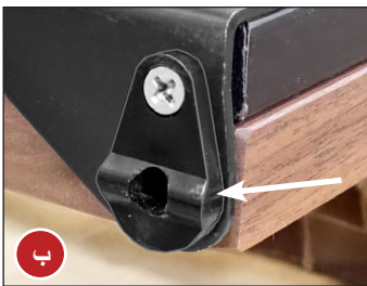
الشكل ٥. أزل ديوس وجلبة المفصلة العلوية (أ)، ورافعة كامه الباب (ب) من كتيفات المفصلة. لا تزل كتيفات المفصلة.
