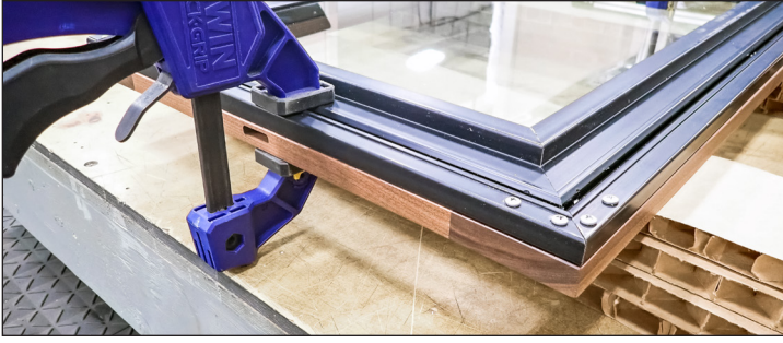
الشكل ٦. تأكد من أن الفتحة المركزية للكسوة موضوعة أعلى الباب.
