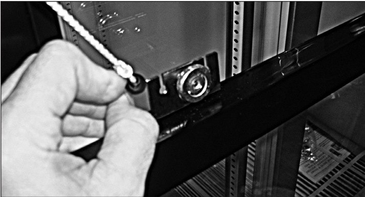
الشكل ٦. حرك اللسان الأسود الحامل لسلك الباب إلى الخارج من الخلف.
