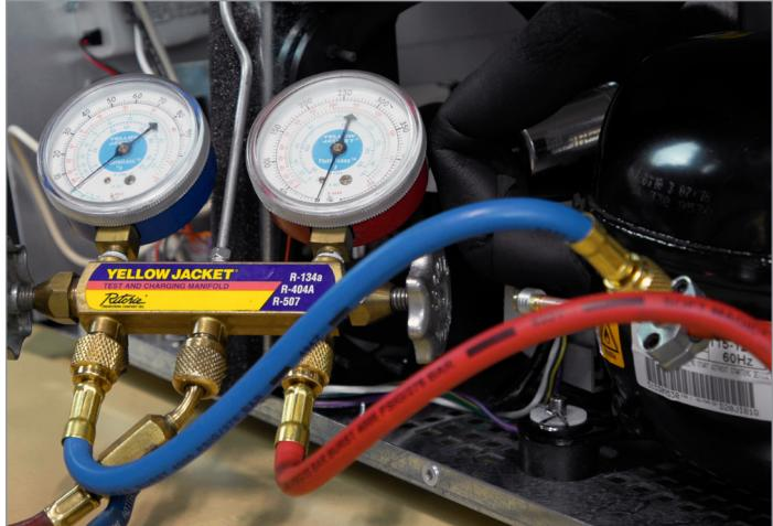
Verwenden Sie für Ihre Messgeräte möglichst kurze Kältemittelschläuche (wegen der geringeren Kältemittelfüllung).
