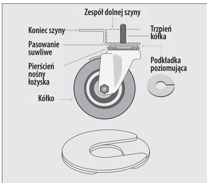
Rys. 4. Trzpień kółka i podkładki. Nałożyć wiele podkładek z przesuniętymi otworami.
