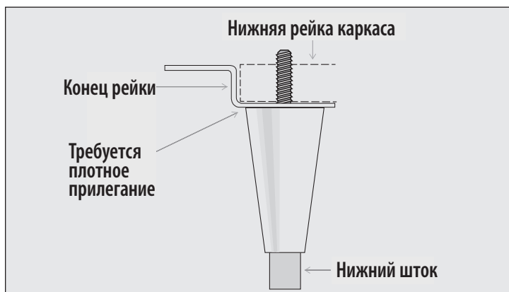
Рис. 2. Детали регулируемой по высоте ножки. Вращать нижний шток для выравнивания устройства по уровню.
