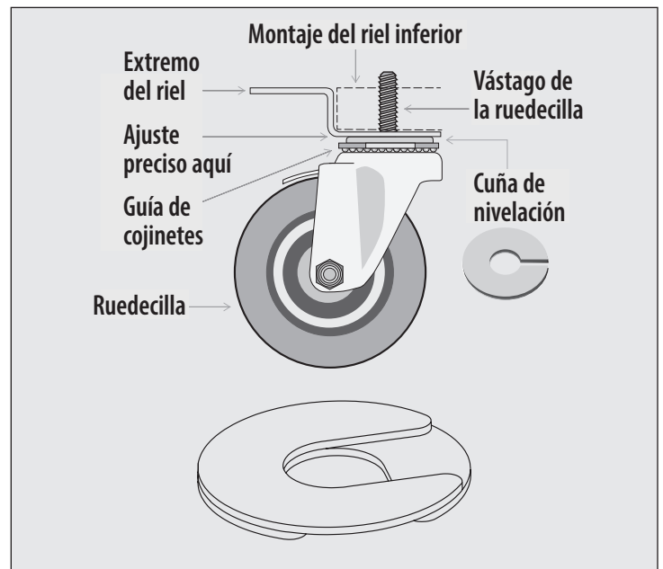
Fig. 4. Ruedecilla y cuñas con vástago. Instale varias cuñas con ranuras desplazadas.
