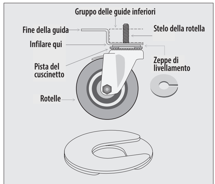
Fig. 4. Rotelle con stelo e zeppe. Installare molteplici zeppe con scanalature equilibrate.
