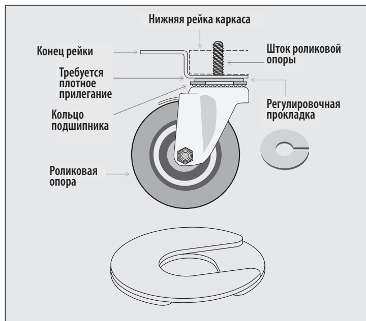
Рис. 4. Роликовая опора со штоком и прокладки. При установке нескольких прокладок следить, чтобы их пазы были смещены относительно друг друга.
