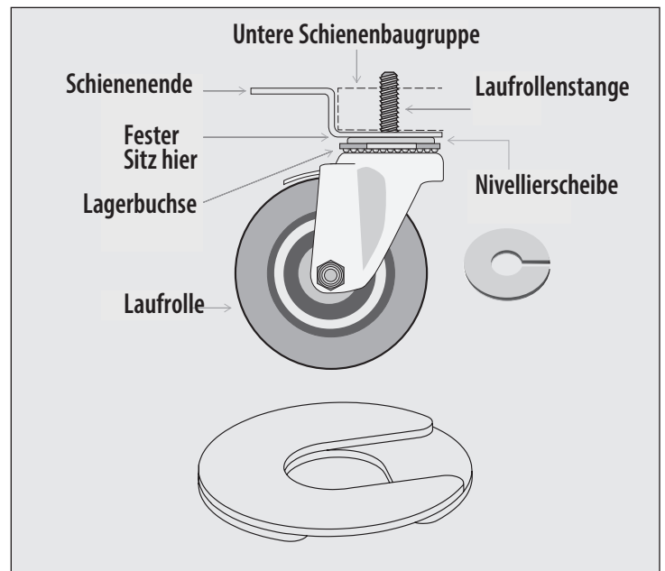
Abb. 4. Stangen-Laufrollen und Unterlegscheiben. Installieren Sie mehrere Unterlegscheiben mit versetzten Schlitzen.
