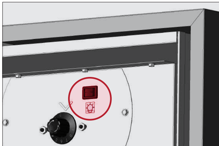
Rys. 1. Przykład symbol oświetlenia i lokalizacji wyłącznika oświetlenia
