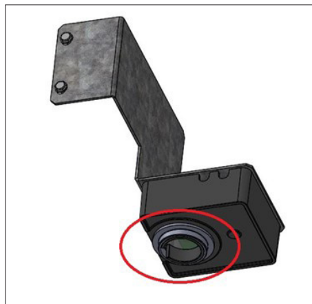
Рис. 2. Место установки линзы датчика уровня льда.
