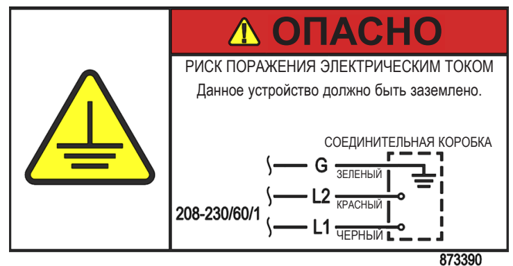
Рис. 3. Выполнить электрические соединения внутри соединительной коробки льдогенератора. Обязательно использовать устройства для снятия механического напряжения. Обязательно использовать зеленый винт заземления при выполнении электрических соединений.
