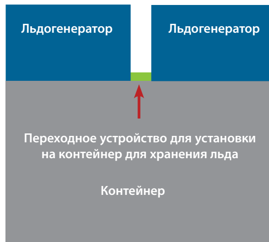
Рис. 2. Льдогенераторы установлены с обеих сторон бункера.
