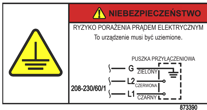
Rys. 3. Wykonanie przyłącza elektrycznego w skrzynce przyłączeniowej kostkarki do lodu. Używać przepustów kablowych. Wykonując przyłącza elektryczne, zawsze należy wykorzystywać zieloną śrubę zaciskową uziemienia.
