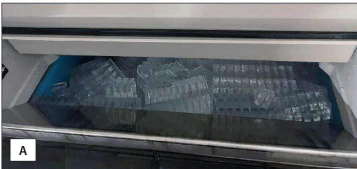
Rys. 5. Zasobnik na lód z przegrodą zrzutową (A) i bez niej (B).
