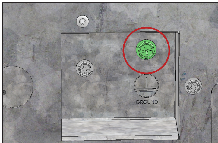
Rys. 3. Wykonanie przyłącza elektrycznego w skrzynce przyłączeniowej kostkarki do lodu. Używać przepustów kablowych. Wykonując przyłącza elektryczne, zawsze należy wykorzystywać zieloną śrubę zaciskową uziemienia.
