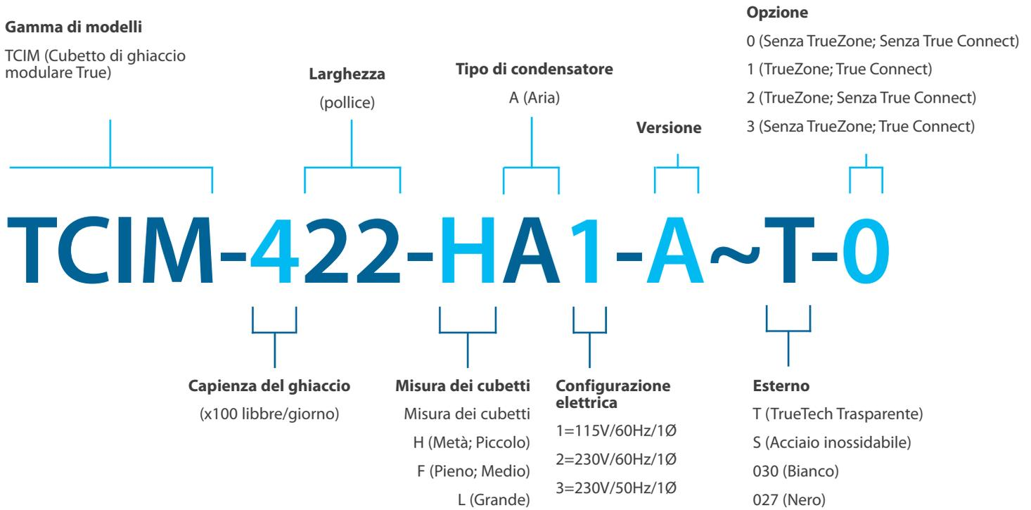
Fig. 2 Diagramma della nomenclatura del modello TCIM.
