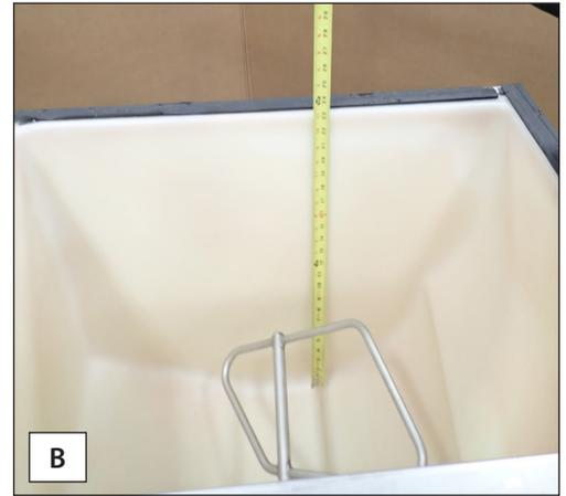
**Fig. 2** Misurare sempre il contenitore (A) o l'erogatore (B) per il sensore del livello del ghiaccio prima di montare la macchina del ghiaccio.
