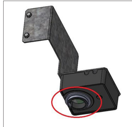
Abb. 2. Ort der Linse des Eisfüllstandsensors.
