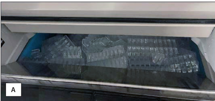
Abb. 5. Eisbehälter mit (A) und ohne (B) Abweiser im Ausgabebereich.
