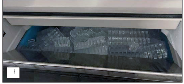
الشكل 5. صناديق الثلج المزودة بالوح العاكس لمنطقة سقوط الثلج من النوع (أ) وليس من النوع (ب).
