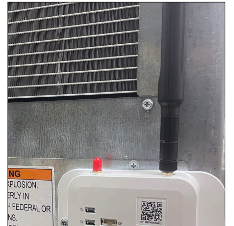
الشكل 3. تركيب الهوائي على جهاز الوصل. قد يختلف الهوائي الخاص بك.
