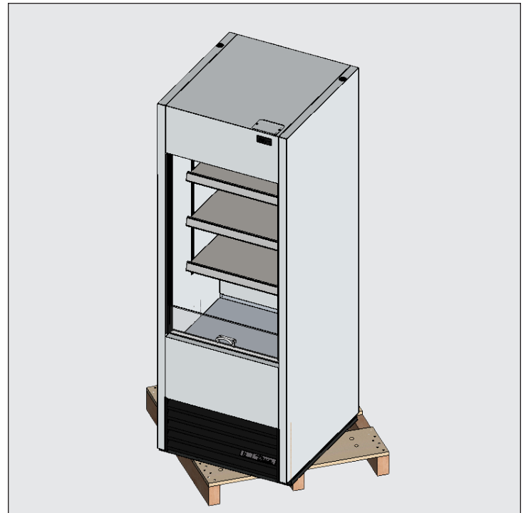
Fig. 3. Al elevar el equipo, no use encimeras, puertas o cajones ni rejillas como punto de elevación.
