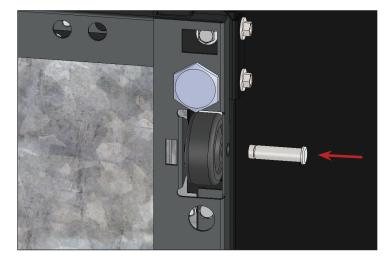
Fig. 12. Insert the pin.
