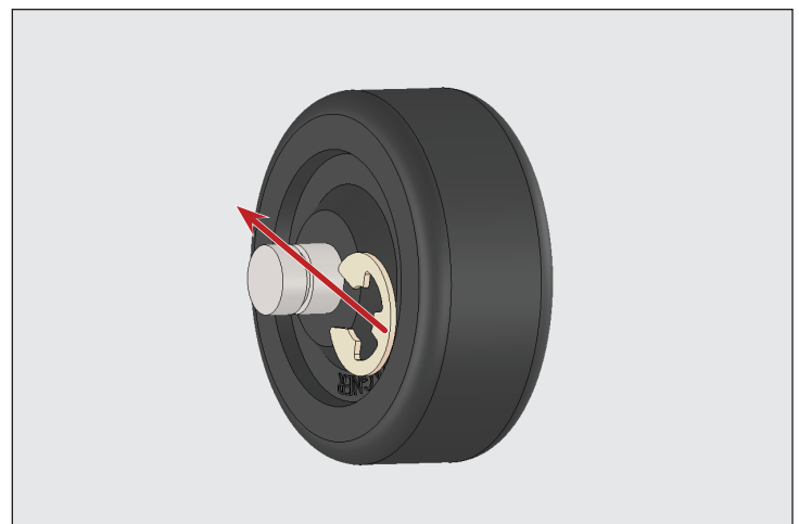
Fig. 13. Instale el anillo de retención.
