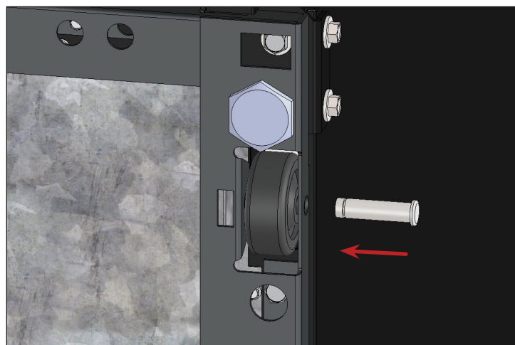
Fig. 12. Insérez la goupille.
