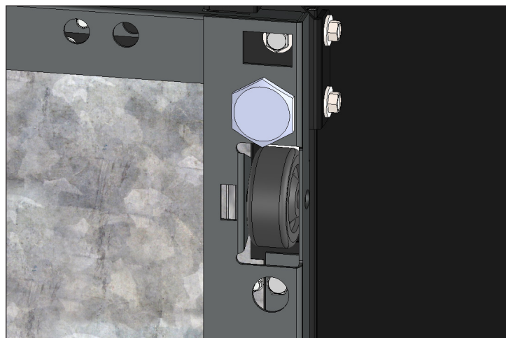
Fig. 11. Positionnez la roulette.
