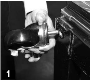
1 Atornille la rueda en la parte inferior de la base del gabinete.
