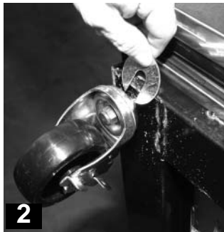
2 Para nivelar inserte la cuña entre la base del gabinete y la de la rueda.
