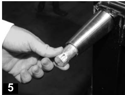
5 El extremo de las patas es ajustable, para una fácil nivelación.
