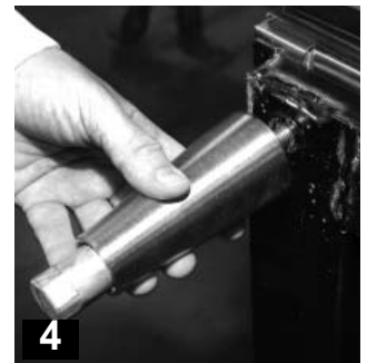
4 Atornille la pata en la parte inferior de la base del gabinete.
