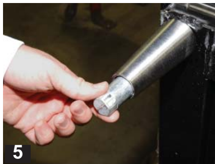
5 Het uiteinde van de poot is verstelbaar, wat het waterpas zetten vergemakkelijkt.
