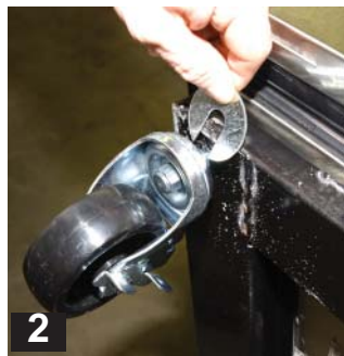
2 Installeer de shim tussen het wiel en de frameraail om waterpas te zetten.
