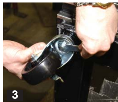
3 Gebruik het meegeleverde gereedschap om het wiel op zijn plaats aan te draaien.
