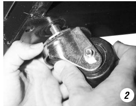
Die Gleitrollen in die vorhandenen Bohrungen für die Fußnivellierer schrauben.
