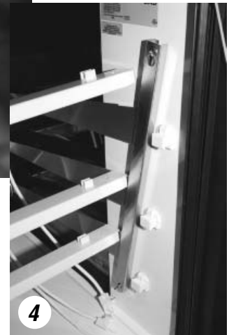
4 Montieren Sie die rückwärtigen Klammern
