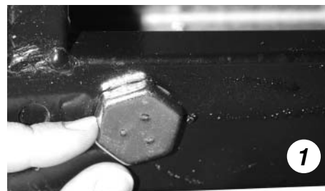
Die Fußnivellierer von Hand oder mit einem verstellbaren Schraubenschlüssel herausdrehen.
