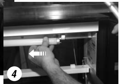
4 Sie die Leuchtröhre leicht in die federbelastete Lampenfassung drücken.
