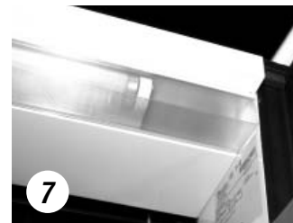
7 Ordnungsgemäß installierte innere, obere Leuchtbaugruppe.
