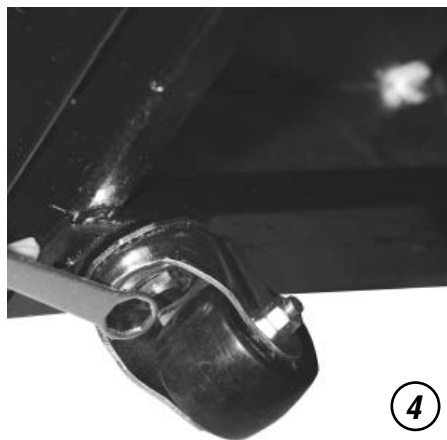
Die Gleitrollen an der vorgesehenen Position mit einem Gleitrollenschlüssel festziehen.
