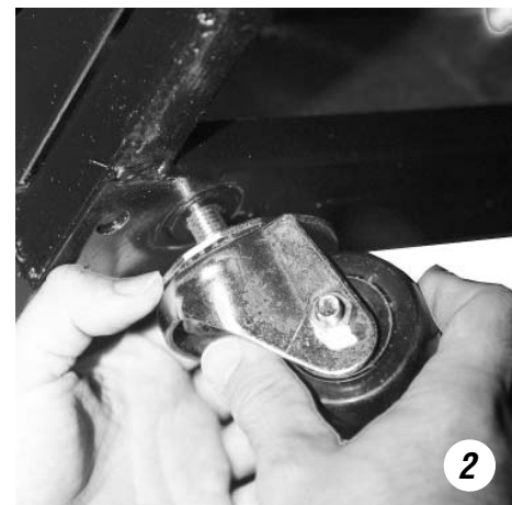
Visser les roulettes dans les trous se trouvant dans les pieds réglables.
