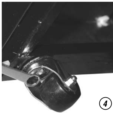
Resserrer la roulette en place avec la clé pour roulette.
