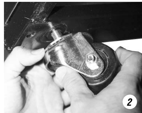
Schroef de wielen in de bestaande gaten van de stelpoten.
